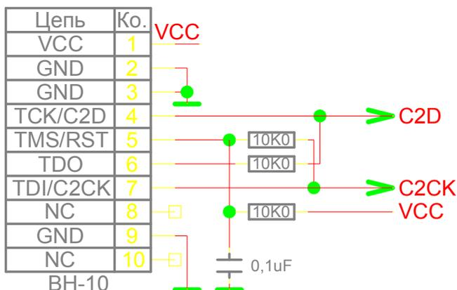
Разъём *BH-10 (2X5 с шагом 2,54 мм) C2-интерфейса* может быть заменён *штыревой линейкой 2X3 с шагом 2,0 мм*. В этом случае *разъём IDC-10* программатора EC2 к *штыревой линейке 2X3 с шагом 2,0 мм* должен быть подключен с помощью специального переходника:
